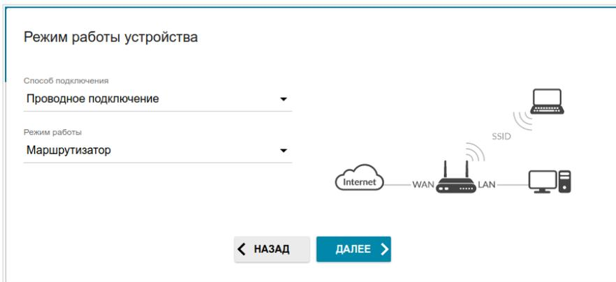
Чтобы подключить Ваше устройство к проводному маршрутизатору для добавления беспроводной сети к существующей локальной сети, на странице **Режим работы устройства** в списке **Способ подключения** выберите значение **Проводное подключение**. Затем в списке **Режим работы** выберите значение **Точка доступа**. В этом режиме Вы сможете изменить IP-адрес локального интерфейса, задать свои настройки для беспроводной сети устройства и задать собственный пароль для доступа к web-интерфейсу устройства.
