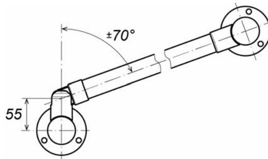
**Рисунок 12. Возможные углы поворота патрубка поворотного типа BH02 0-11**
